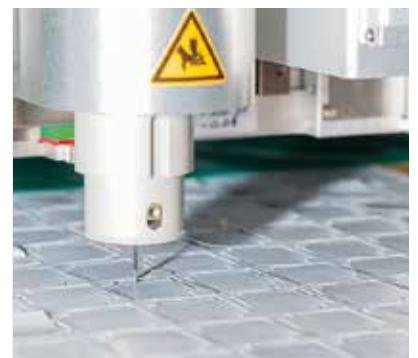
CNC-Plotterschneideanlage – Zuschnitt und Punch
