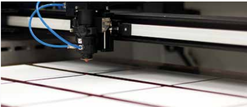
CO 2 – CNC-Laseranlage – Keramikbearbeitung
