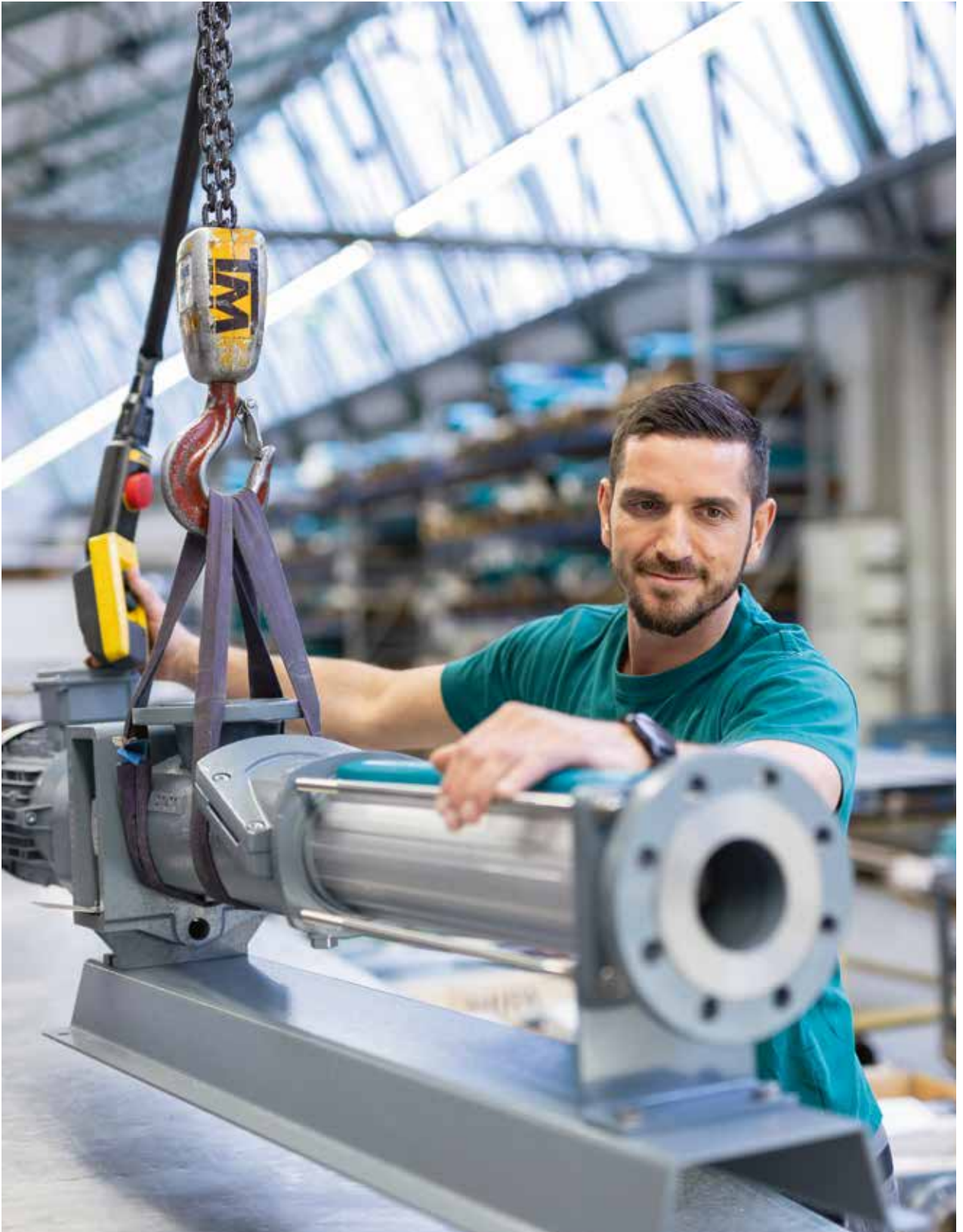
Die NEMO® Exzentrerschneckenpumpe bei ihrer Montage
